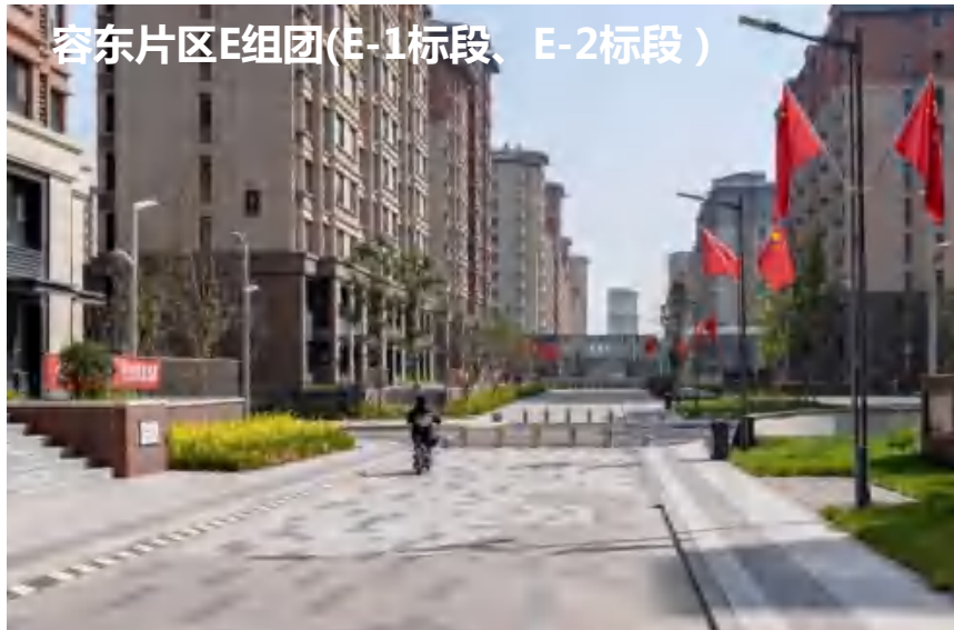
慢行化支路起始端设升降式阻车桩，变化铺装材质
